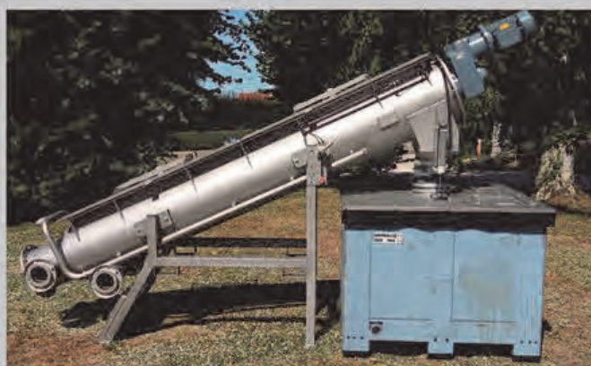
Séparateur de boues
