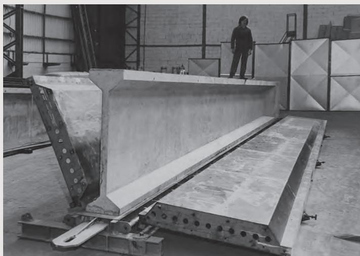
*Moule et sa pièce béton préfabriquée.*
