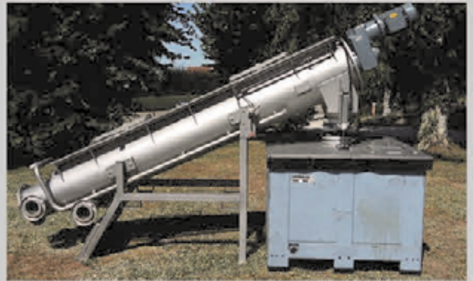
Séparateur de boues
